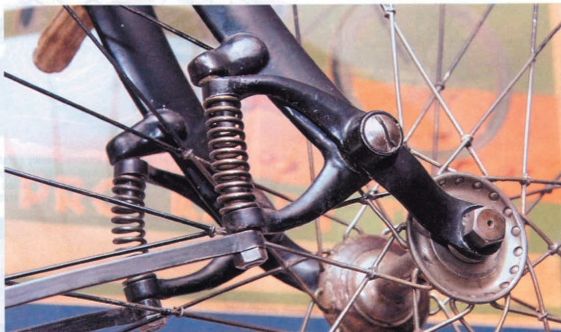
Americká značka Columbia používala jednoduché řešení odpružení přední vidlice
