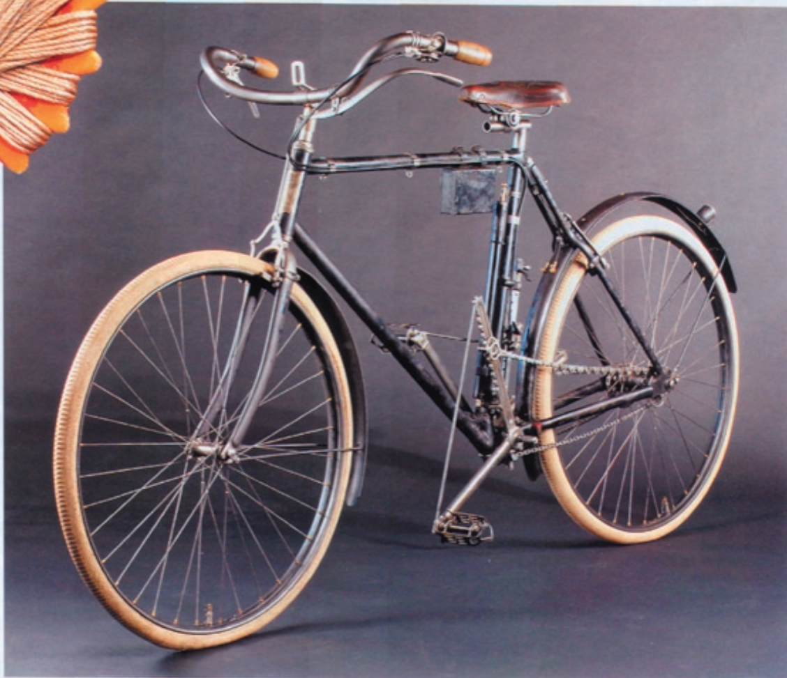
Francouzské kolo značky Terrot Levocyclette, vyráběné v letech 1905 až 1915, používalo k pohonu kliky, které se pouze stlačovaly směrem dolů. Pohon dvěma řetězy byl zajištěn přes jakési šnekovité pastorky. Stroj využívající stejný systém pohonu, byl s velkou slávou představován na letošním Eurobiku v německém Friedrichshafenu
